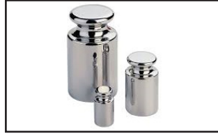
الوحدات المرجعية للكتلة (الأثقال الفولاذية)
